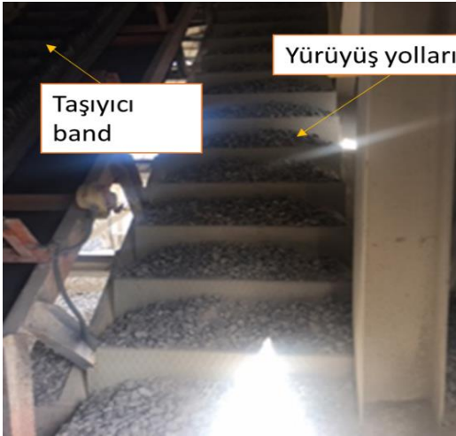
Şekil 2. Kovalı bantlar fazla besleme sonucu taşma
